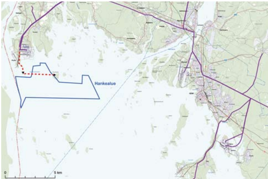
Kuva 3-13. Suunnitelmapaketti tuulivoimapuiston sähköasemien kytkeisestä Selleen sähköasemalle.
